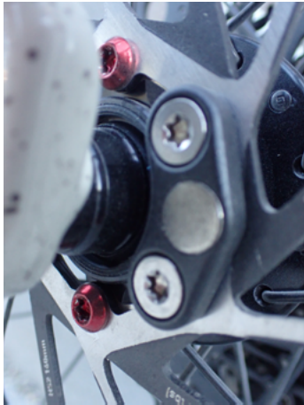
6-Loch-Magnete funktionieren mit dem System
