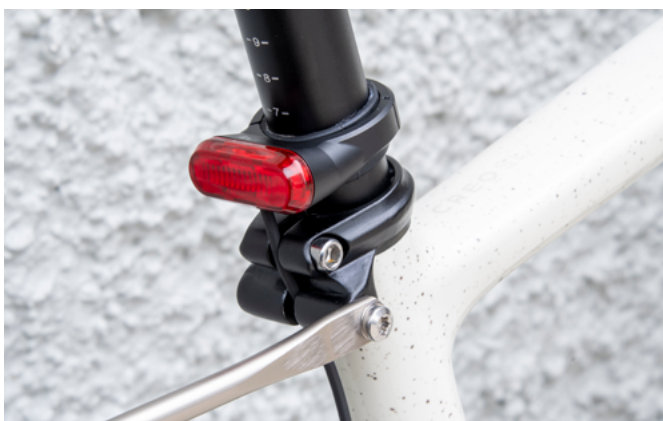
Die Lupine C14 SP ist eine gute Lösung, wenn eine Sattelstützenklemme mit integrierter Gepäckträgerbefestigung montiert wird
