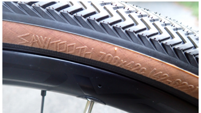
Sawtooth 42c-Reifen auf Roval Terra C-Felge, mit Schläuchen
