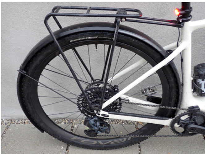
Gepäckträger und Schutzbleche teilen sich die unteren Befestigungspunkte
