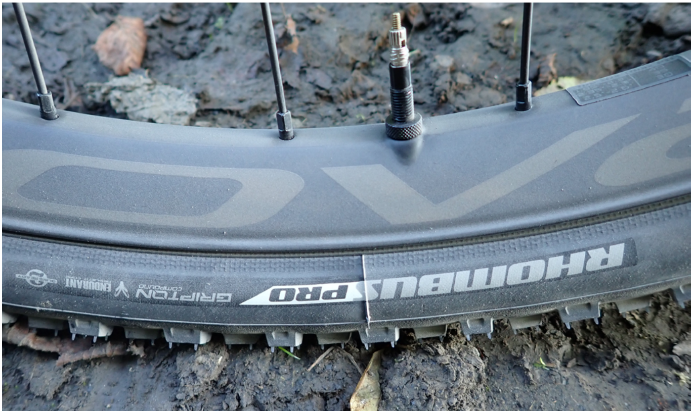
Rhombus Pro 47c Reifen auf Roval Control Carbon Felge, Tubeless
