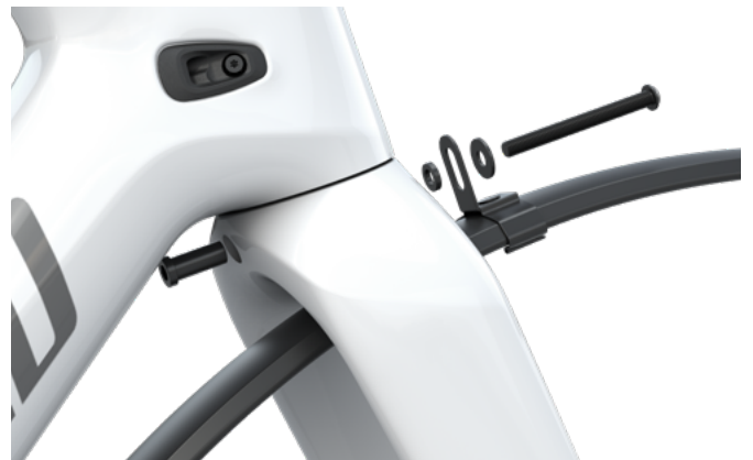
Die Gabelkrone verfügt über ein zentrales Montageloch für die Montage des Schutzblechs - Hardware ist nicht enthalten
