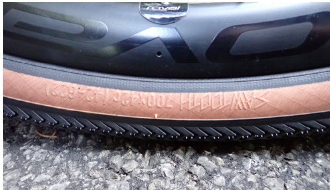
Sawtooth 42c-Reifen auf Roval Terra C-Felge, mit Schläuchen
