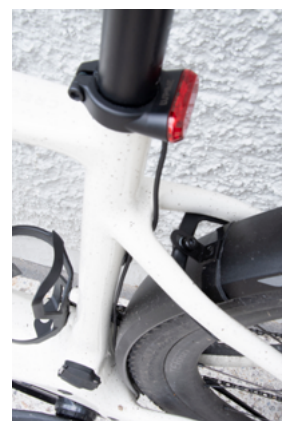
Das Kabel des Rücklichts wird mithilfe der mitgelieferten Kabelklemmen mit selbstklebenden Flickern an der Rückseite des Sitzrohrs entlang geführt
