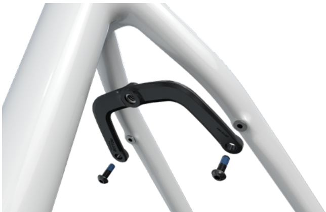
Das hintere Rahmendreieck verwendet die mitgelieferte Halterung zur Montage des Schutzblechs
