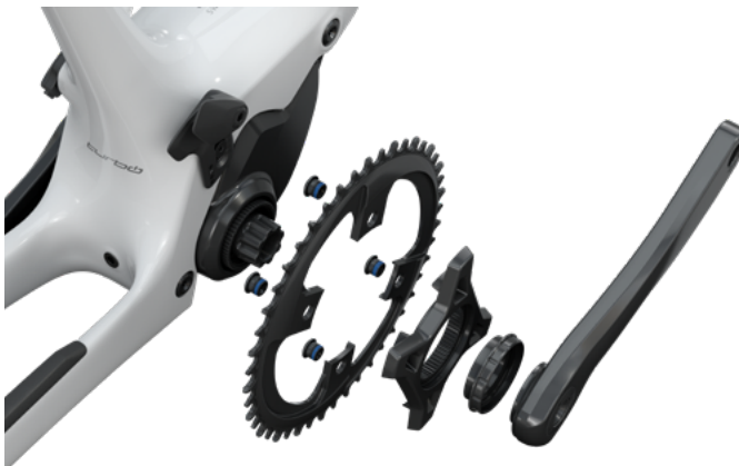
Der Spider nimmt Kettenblätter mit 107 BCD auf; es werden passende SRAM X-Sync-Kettenblätter empfohlen
