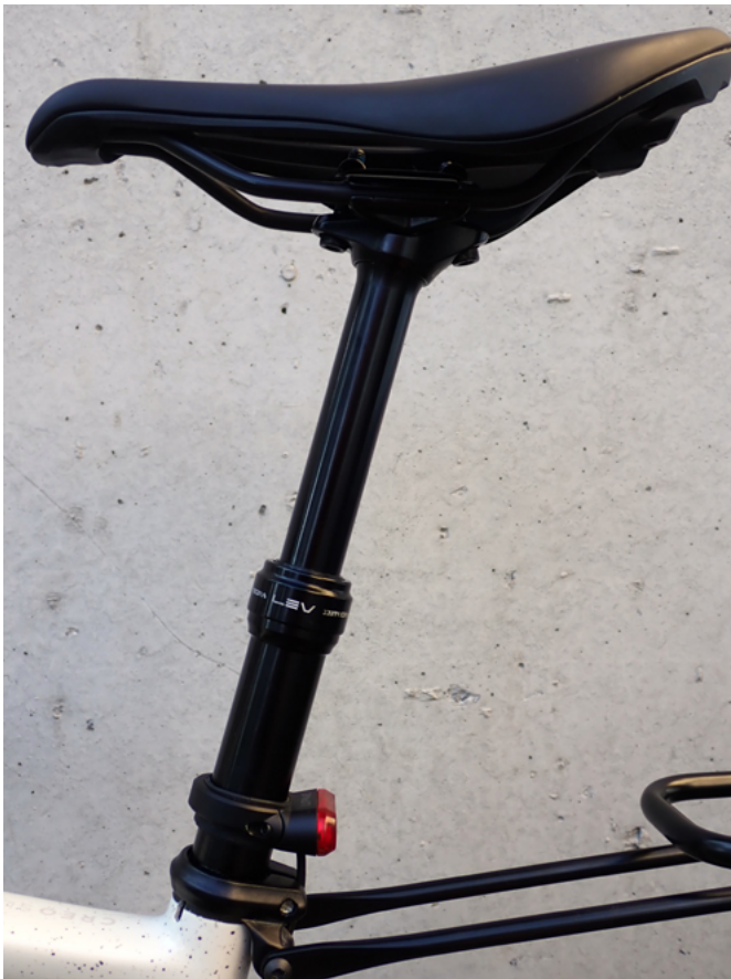
Eine Kind Shock LEV Integra 27.2 Sattelstütze mit 100 mm Hub, eingebaut in einen Rahmen der Größe 56
