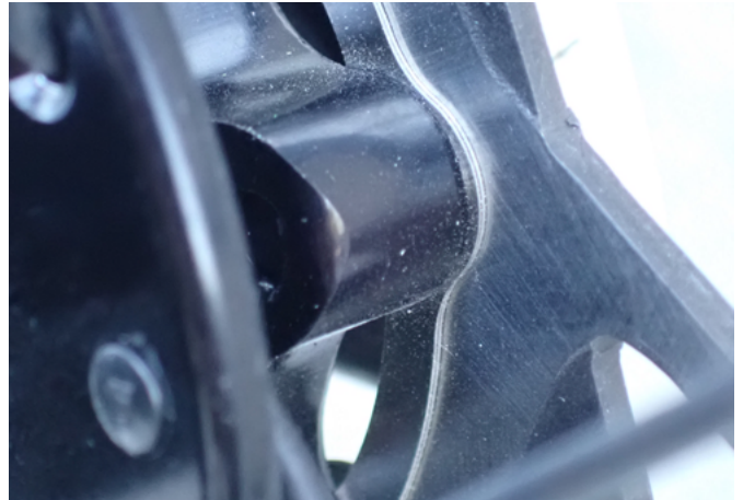
Eine 6-Loch-Bremsscheibe auf einem zweiten Laufradsatz, mit 2x 0,2 mm Ausgleichsscheiben zur Ausrichtung
