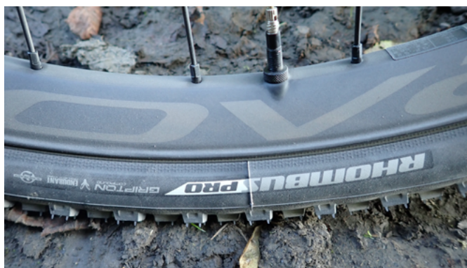
Rhombus Pro 47c Reifen auf Roval Control Carbon Felge, Tubeless
